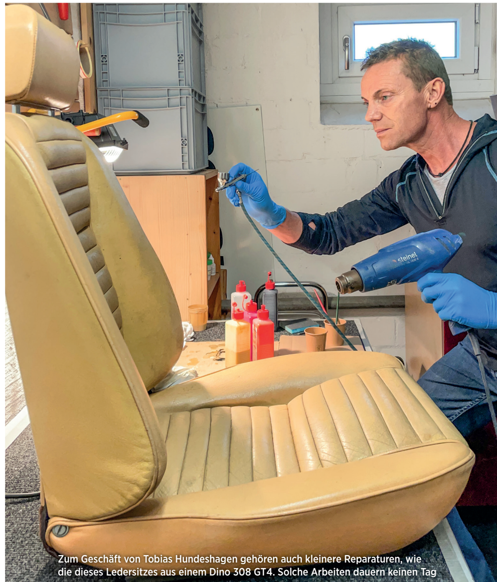
Bevor Tobias Hundeshagen auf den Plan tritt, müssen die Nähte der quer auf der Sitzfläche...
