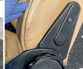
Der erste Auftrag erfolgt mit dem Pinsel, damit die weiße Grundierung abgedeckt wird. Die Farbanpassung erfolgt wieder im Spritzverfahren
