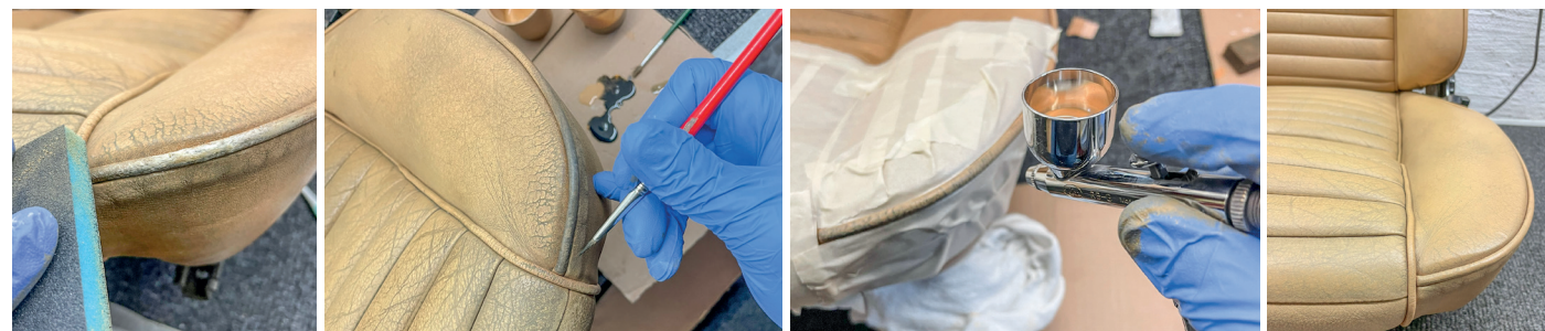
...Flüssigleder nach. Wenn das trocken ist, wird mit einem Schleifpad nachbearbeitet. Mit einem dünnen Pinsel imitiert er anschließend die Struktur und den Alterungsgrad des umgebenden Bereichs, schließlich soll die Reparatur anschließend unsichtbar sein. Zum Schluss wird nachpigmentiert – fertig
