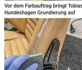
Nach dem Trocknen ist die Grundierung weiß und wird geschliffen
