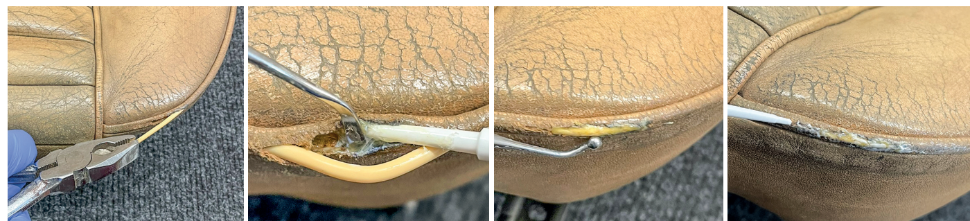
Schadensanalyse: Die Kederseele ist nach hinten gewandert, das dünne Leder, das sie umschließt, an der vorderen Sitzecke durchgescheuert. Im ersten Schritt zieht Tobias Hundeshagen die Seele mit einer Zange nach vorne und bringt sie in die ursprüngliche Position. Dann modelliert er den Keder mit...
